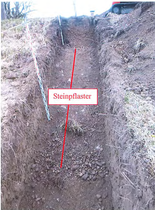
Abb.5: Baggerschurf SCH 2 Blickrichtung Deich
