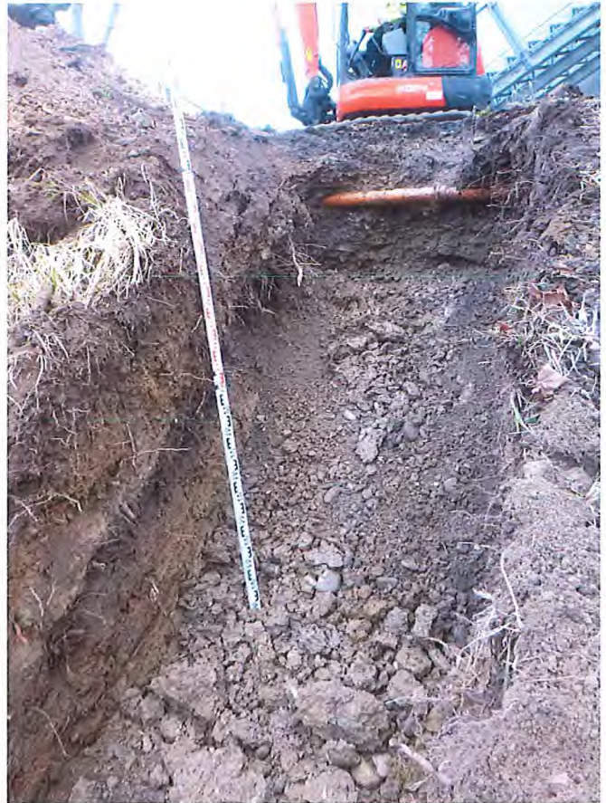
Abb.11: aufgebrochenes Steinlager in Schurf SCH3 Abb.12: Baggerschurf SCH 3 im Deich
