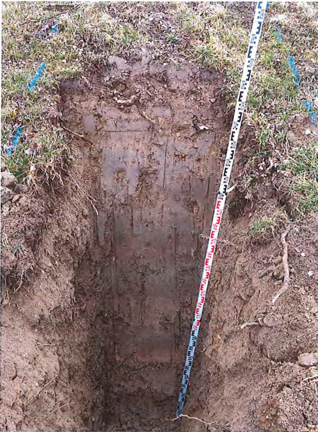
Abb.18: Baggerschurf SCH 6 im Deich
