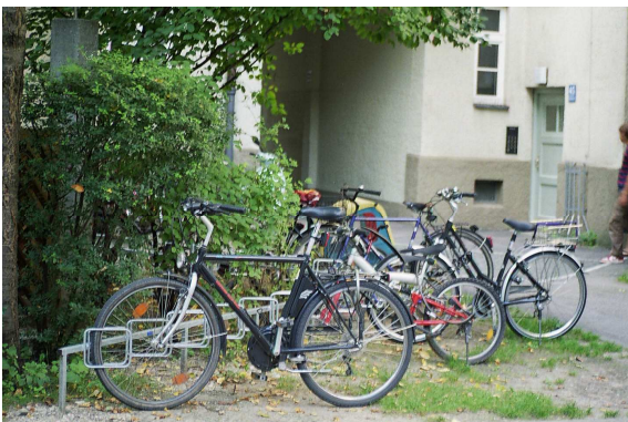
Schlechter Fahrradständer (Vorderradklemme)
